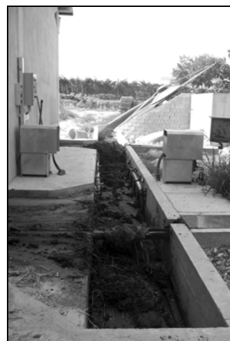
Particolari: raschiatore e nastro per l'asporto del letame
