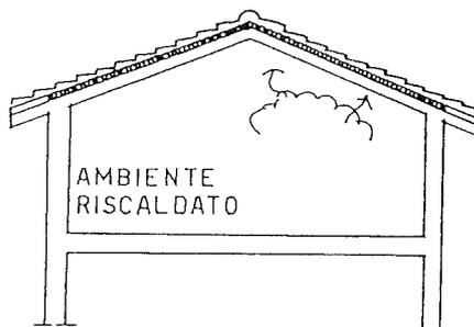
Fig. 2 - Schema di copertura isolata non ventilata.
